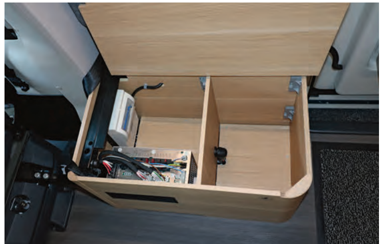
In der Seitensitzbank ist die komplette Elektroanlage perfekt zugänglich und sogar noch als Stauraum nutzbar.
