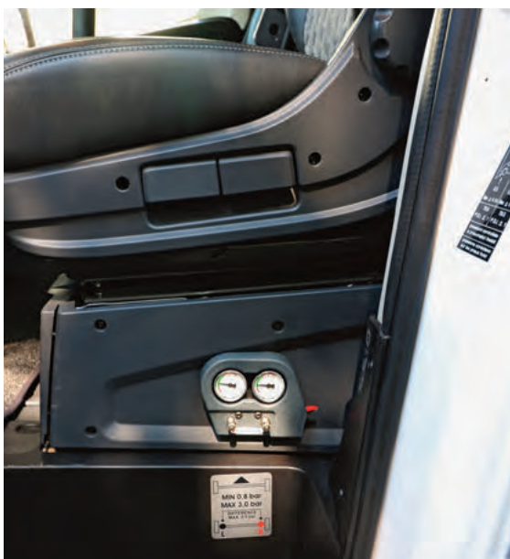
Kontrollinstrumente für den richtigen Wert der Hinterachs-Luftfederung.
